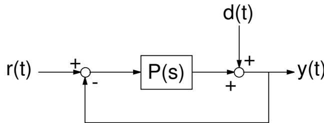
dove  $P(s) = k_P \frac{1 + \frac{2s}{7}}{1 - 13s + \frac{s^2}{2}}$ , con  $k_P$  parametro da determinare. Si indichi con  $W(s)$  la funzione di trasferimento del sistema da  $r$  a  $y$ , e con  $W_d(s)$  quella da  $d$  a  $y$ .
