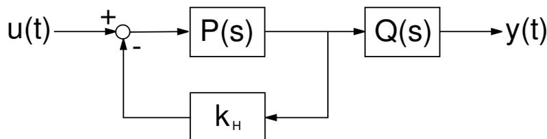
dove  $P(s) = \frac{s+3}{s^2+s-4}$ ,  $Q(s) = \frac{s+1}{s+4}$ , e  $k_H \in \mathbb{R}$  è un parametro incognito. Si indichi con  $W(s)$  la funzione di trasferimento del sistema da  $u$  a  $y$ .
