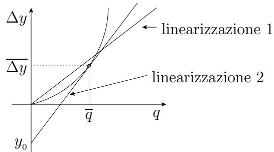
Linearizzazione 2:  $\Delta y = R q + y_0$  ,  $R$ =resistenza idraulica  $\left[\frac{s}{m^2}\right]$
